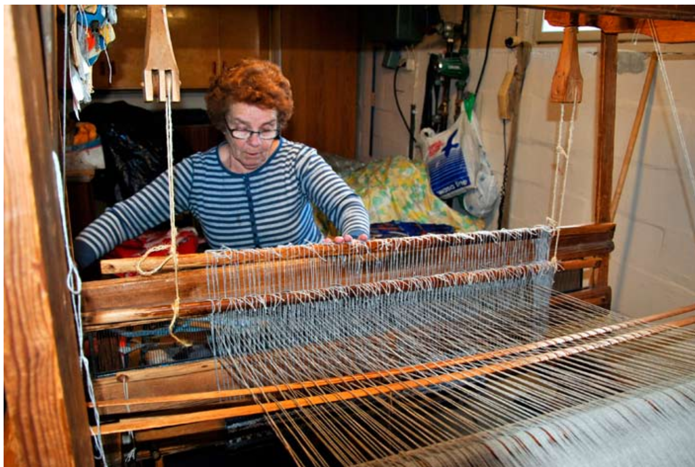
Anna-Lisa Damsten väver en matta. Varpen löper från bommen genom skafte , som ger schäle när vävaren trycker ner tramporna.
