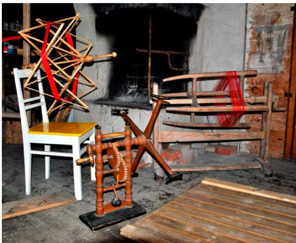
Härvel med kugghjul och kläpp, som smäller efter 60 varv. Garnet från nöstfåoti rullas upp på båttji i båkkståoli .
