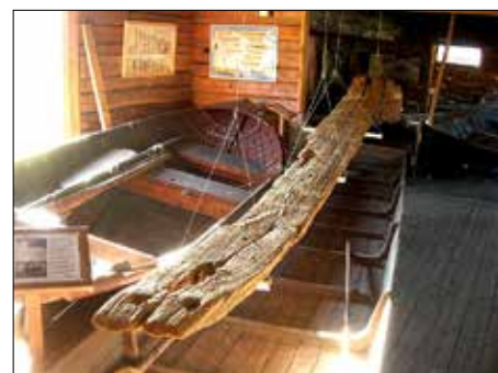
De olika bottenplankdelarna från 1774 har sammanfogats och hänger fritt från taket i båtmuseet. Undertill en ekstock byggd 1920, även den från Lappfjärd. Till vänster Gösta Ågrens Maxmojolle .
