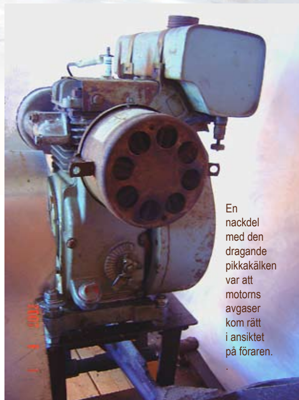
Pikkakälken är tillverkad av Sigfrid Vestergård (trädelar, jämbeslag) och Kalle Björkqvist (hjulet, svets- ning) i Molpe i början av 1960-talet. Motor: Bernard W 39 A, ca 1,5 hk. Donerad av Karl-Johan Häggdahl, Molpe, till Kvarkens båtmuseum 2007. Kat.nr 2313.
