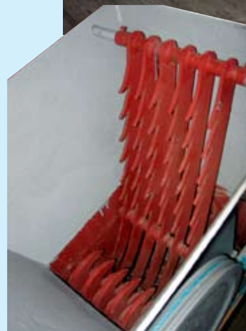
Iskvarnen i Kvarkens båtmuseum. T.v. iskvarnens tratt med ”gallret” och gripgafflarna längst ner. Bilden nedan visar tratten sedd rakt uppifrån.
