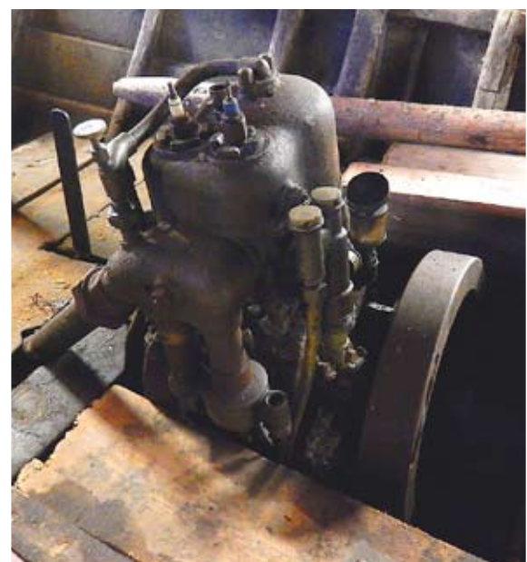
Rukinen-motorn i Klavus skötbåt (byggd c. 1912) i Kvarkens båtmuseum: modell från åren 1913–1916, 5–6 hk, 1 cylindrig, 4-taktsmotor. Tillverkad i Finland.
