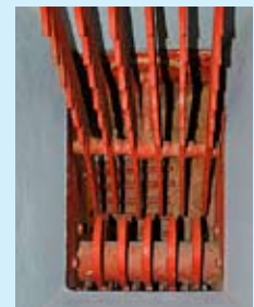
Iskvarnen i Kvarkens båtmuseum. T.v. iskvarnens tratt med ”gallret” och gripgafflarna längst ner. Bilden nedan visar tratten sedd rakt uppifrån.
