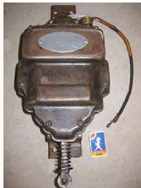
Skylten ovan hör ihop med WICO-magneten till höger. Magneten till vänster har tillhört en båtmotor i Äminne, Malax. Båda magneterna gäller för encylindriga båtmotorer.
