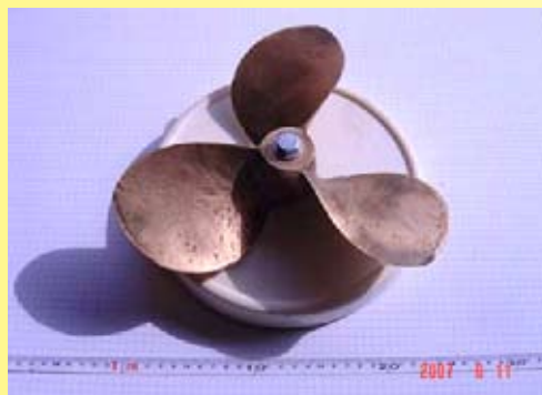
De mörka märkena visar att propellern är klappad (efter att den törnat mot stenar m.m.)
