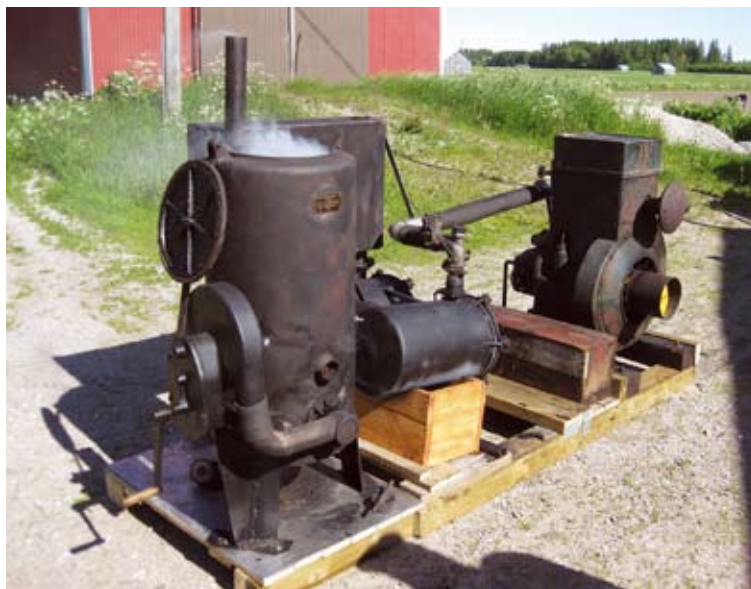
Wilhelm Tallgrens gengasaggregat med motor. Ritningen om förbränningsmotorteknik är från Hermods korrespondensinstitut, 1960.
