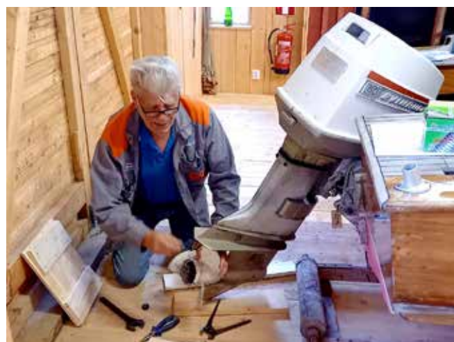
Talkoledaren Mikael Storfors kan det mesta, inte minst när det gäller motorer. Här gör han ett gångskydd runt Felicia-båtens aktersnurra.
