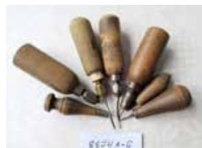
Skomakarens viktigaste verktyg var sylar, pryklar, knivar, tänger, hammare och rasp samt läster av trä runt vilken skon formades och syddes. Pryklar har en kantig form på spetsen. Sylar har runda och vassa spetsar. De användes för håltagning i lädret.
