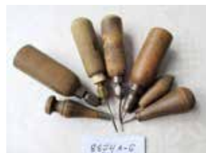
Skomakarens viktigaste verktyg var sylar, prylar, knivar, tänger, hammare och rasp samt läster av trä runt vilken skon formades och syddes. Prylar har en kantig form på spetsen. Sylar har runda och vassa spetsar. De användes för håltagning i lädret.
