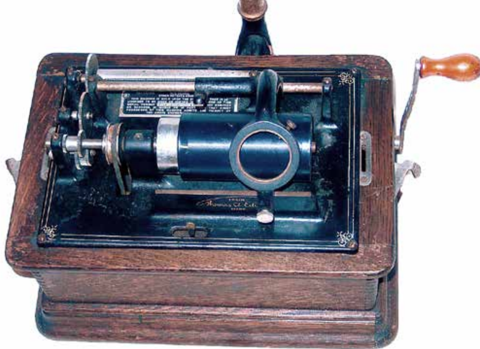
Fonografen som finns i Brinkens museum är sannolikt en "Edison Standard Phonograph, Type D", en typ av fonograf som tillverkades 1908–1911.
