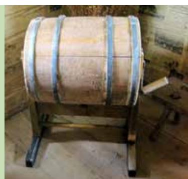
Vevkärna. Den vevdrivna horisontella axeln inne i kärnan är försedd med perforerade ”vingar”.
