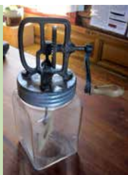
Vevkärna. Den vevdrivna horisontella axeln inne i kärnan är försedd med perforerade ”vingar”.
