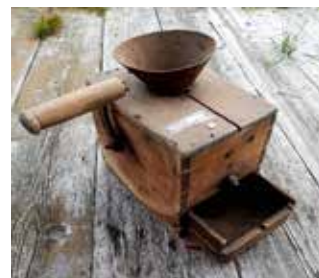
Tobakskvarn (Kessokvään) vid Brinkens museum. I kvarnen skars och malades de torkade tobaksbladen. Den malda tobaken malades och siktades flera gånger för att tobaken skulle bli så fin som möjligt.
