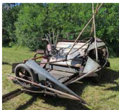
Självavläggaren New Buckey från företaget Mc Cormick . Vinghaspelns räfskammor lade av stråsädeshoparna bakom maskinen så att de inte var i vägen vid nästa skärvar. Räfskammorna lyftes automatiskt när de gick över körkarlen. Vid skörd med Skärverk och de enklare självavläggarna lades hoparna direkt bakom samlingsgrinden, vilket hade den nackdelen att alla sädeskärvar måste vara bundna och flyttade före nästa skärvar. Bildkälla: Ny illustrerad tidning 1874. Bilden är också publicerad i Eskeruds bok.
