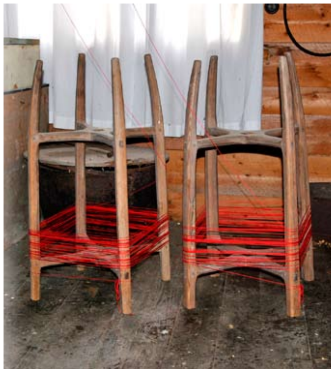
Båkkarna uppställda för varpning
