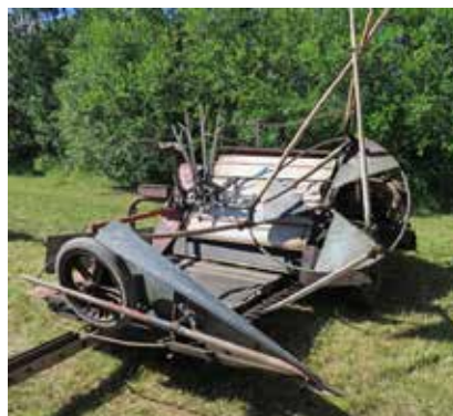
Själavläggaren New Buckey från företaget McCormick . Vinghaspelns räfskamar lade av stråsådeshoparna bakom maskinen så att de inte var i vägen vid nästa skärvar. Räfskammarna lyftes automatiskt när de gick över körkarlen. Vid skörd med Skärverk och de enklare självavläggarna lades hoparna direkt bakom samlingsgrinden, vilket hade den nackdelen att alla sädeskärvar måste vara bundna och flyttade före nästa skärvar. Bildkälla: Ny illustrerad tidning 1874. Bilden är också publicerad i Eskeruds bok.
