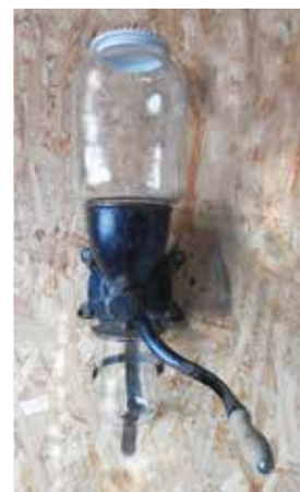
Väggekaffekvarn med kvarnhus av gjutjärn, glasbehållare upptill för kaffebönorna och undertill för det malda kaffet. Ovanlig kvarn med glasbehållare för kaffebönor. De flesta väggekvarnar har porslinsbehållare. Sven-Erik Sundbäck donerade kaffekvarnen till Brinkens museum 2016.
