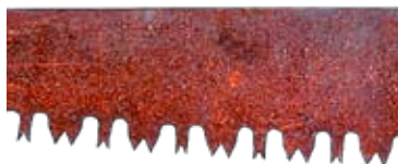
Stocksågen har ett handtag i vardera ändan. Det krävdes två man för att såga med en stocksåg. Stocksågarna har långa och kraftiga sågtänder. "Justersåg" är en annan benämning på stocksåg. Längd 151 cm, bladbredd på mitten 13,5 cm. Brinkens museum.
