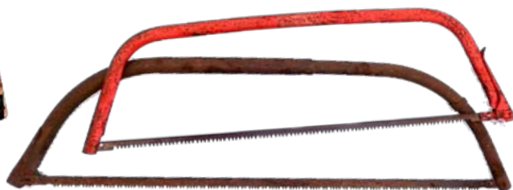
Röda bågsågen: längd nedtill 99 cm, sågdjup 23 cm, bladbredd 2,0 cm. Bruna bågsågen: längd nedtill 116 cm, 24 cm, bladbredd 2,6 cm.
